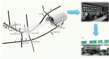
ระบบอุปกรณ์โครงข่ายควบคุมสัญญาณไฟจราจร (ATC)
