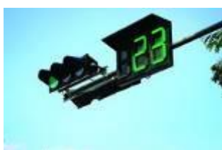
เครื่องนับเวลาถอยหลังสัญญาณไฟจราจร
