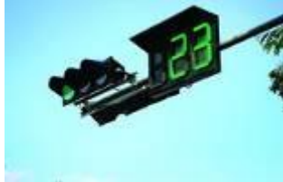
เครื่องนับเวลาก่อนเปลี่ยนสัญญาณไฟจราจร
